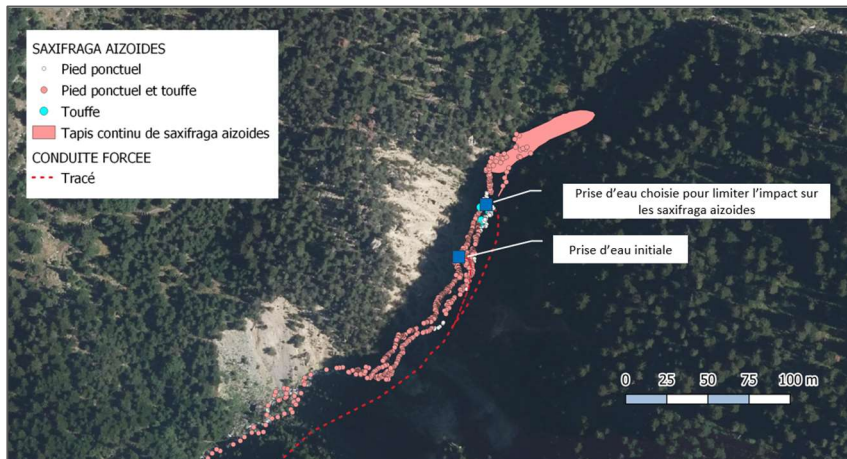
Localisation du déplacement de la prise d'eau
